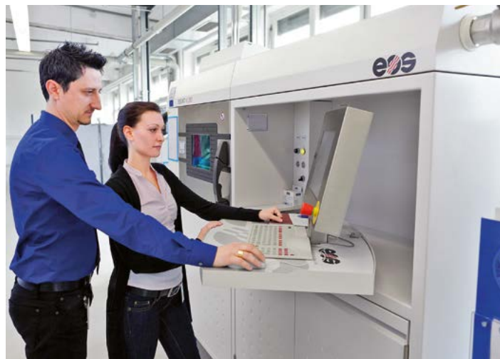
Einblick in die Fertigung: eines der sieben EOS-Systeme, mit dem Serienbauteile für den Triebwerksbau hergestellt werden (Quelle: MTU Aero Engines).
