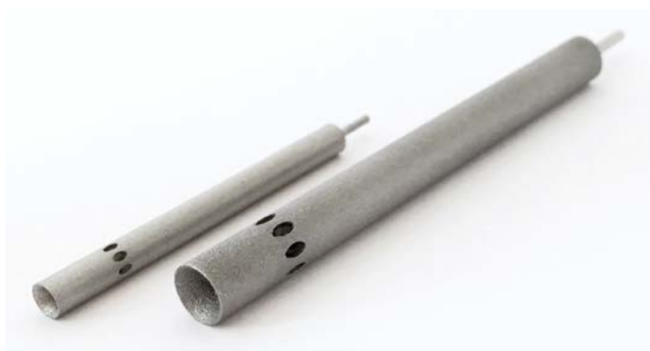
Kielsonden, mit denen der Totaldruck im Triebwerksbereich gemessen wird. (Quelle: Vectoflow)
