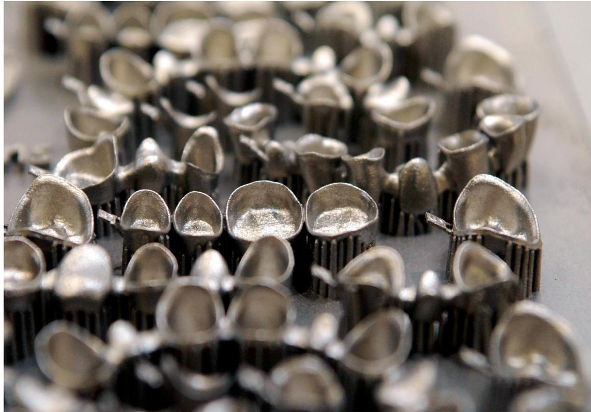
*Ein auf Grundlage eines CAD-Modells geführter Laser stellt durch Verschmelzen von Legierungspulver dünne Querschnittsschichten her. So „wachsen“ automatisch vollständige 3D-Zahnersatzlösungen, hier noch mit Stützstrukturen, heran (Quelle: EOS GmbH).*
