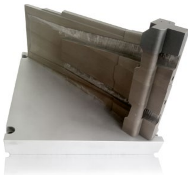
Additiv gefertigtes Werkzeug auf Bauplattform: Die Verwendung der EOS-Technologie trug zu einem längeren Wartungsintervall bei und löste das Problem mit der Luftfeuchtigkeit und der dadurch beschleunigten Korrosion vollständig (Quelle: Innomia).
