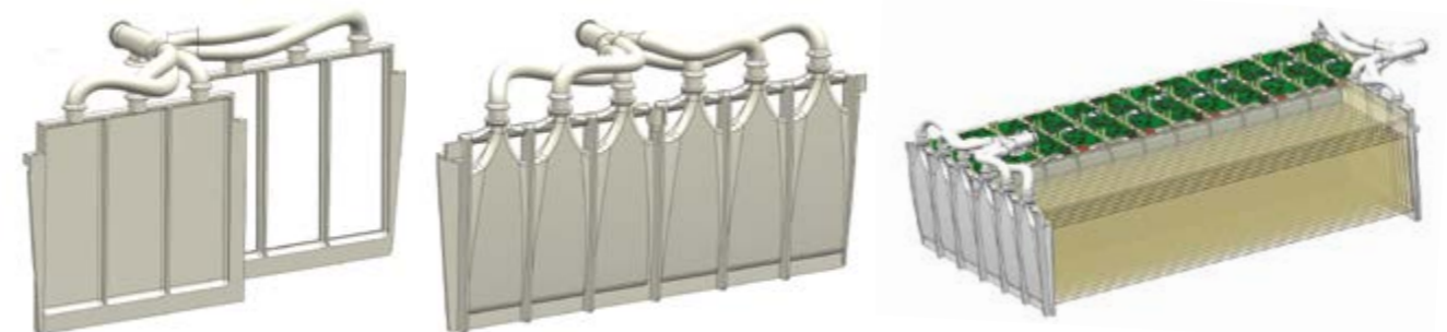
Ein komplexes Batteriesystem erfordert eine leistungsstarke Wärmeabfuhr – kein Problem dank additiver Fertigung (Quelle: GreenTeam Uni Stuttgart)
