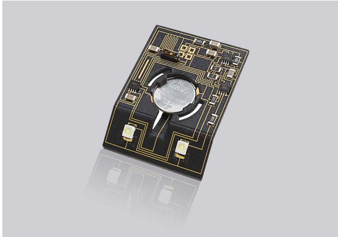
Bestückter und damit funktionsfähiger Schaltungsträger, der mittels additiver Fertigung aus PA 3200 GF hergestellt wurde. (Quelle: Beta LAYOUT)
