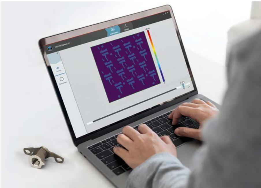
Die MTU Aero Engines setzt bei der Prüfung additiv gefertigter Bauteile auf das schichtweise Live-Monitoring des Bauprozesses mittels EOSTATE ExposureOT.
